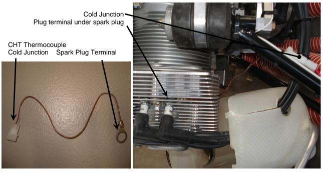
Figure 25. CHT Sender (Thermocouple) Installation
