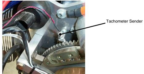
Figure 18. Tachometer Sender Installation
